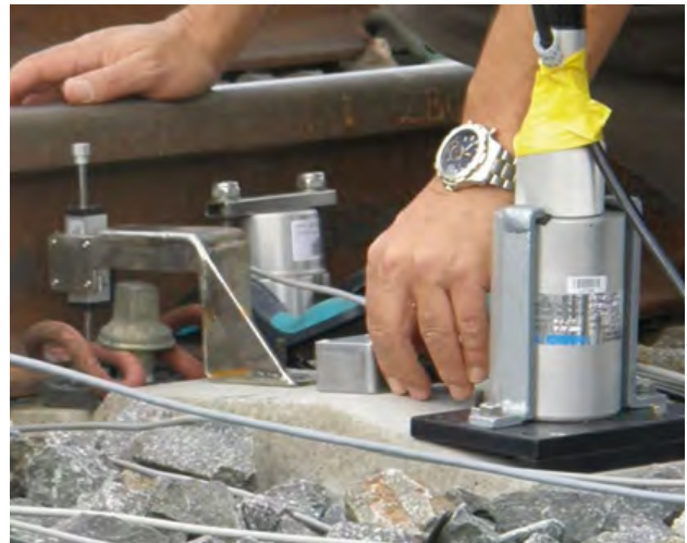
Foto 31. Potenciómetro para medida de movimiento relativo traviesa - carril.
