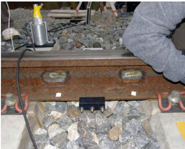
Foto 29. Bandas extensométricas en puente completo para la medida de cargas y reacciones sobre traviesas.
