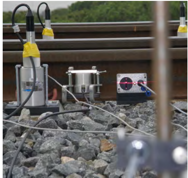
Foto 30. Medida de deflexiones en traviesa (geófono izquierdo) y carril (geófono central y láser).
