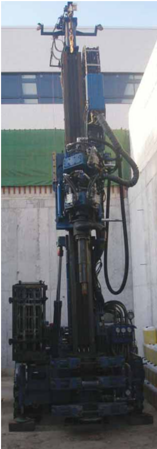
FIGURA 3. Equipo de perforación geotérmico (Fuente: Geoter).
