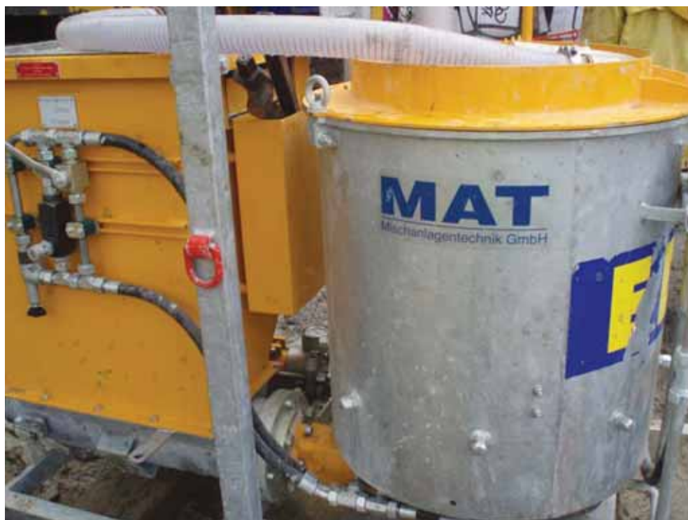
FIGURA 6. Máquina Mezcladora utilizada en trabajos con ThermoCem. (Fuente: Geoter-Edasu).
