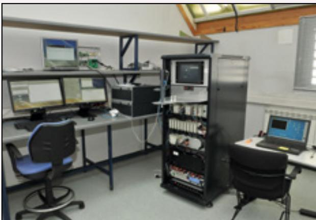
La arquitectura del laboratorio es compatible con la especificación europea incluida en las Especificaciones Técnicas de Interoperabilidad para el Subsistema de Control, Mando y Señalización y recogida en el documento UNISIG-Subset-094 "Functional requirements for on board reference test facility" v.2.0.2 y 3.0.0.
