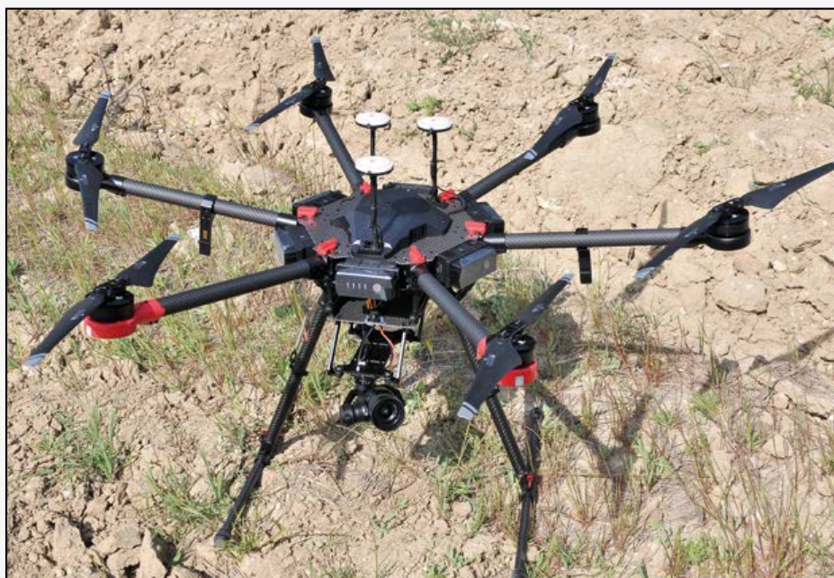
Figura 2. Aeronave tripulada remotamente (Remotely Piloted Aircraft o RPA) del CEDEX para la inspección de estructuras.
