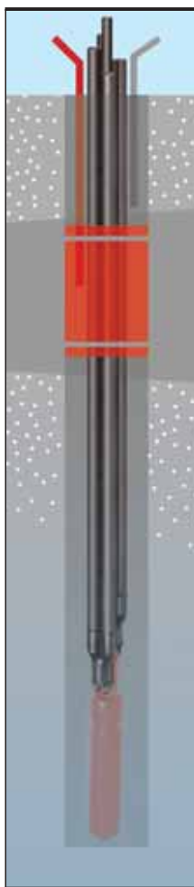
FIGURA 3. Esquema de sonda geotérmica doble con tubo central para cementación y lastre suspendido del pie de sonda. Fuente: HakaGerodur.
