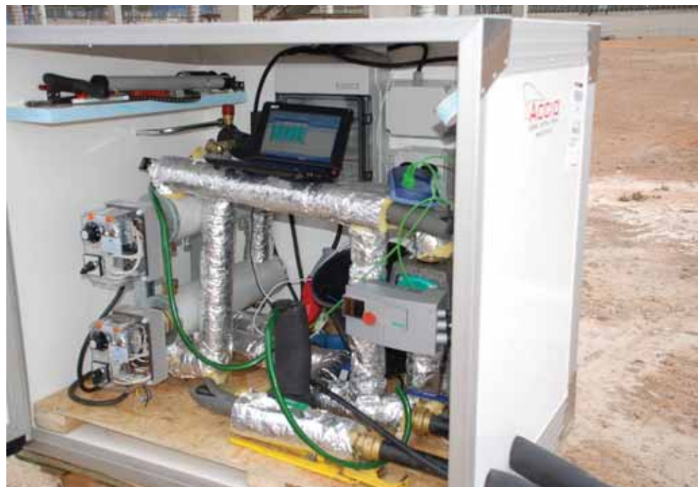
FIGURA 11. Interior de un equipo para ensayo de respuesta térmica del terreno. Fuente: Girod.
