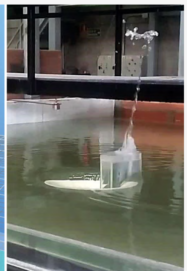
Figura 3. Aliviadero en pozo de la presa de Nagore (Navarra). Fenómenos de aire ocluido en la galería de descarga.
