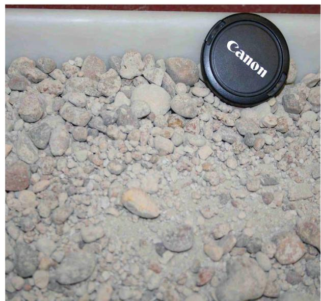
**Figura 9.** Aspecto de las gravas mezcladas con arcilla (Grava + 15% AV).
