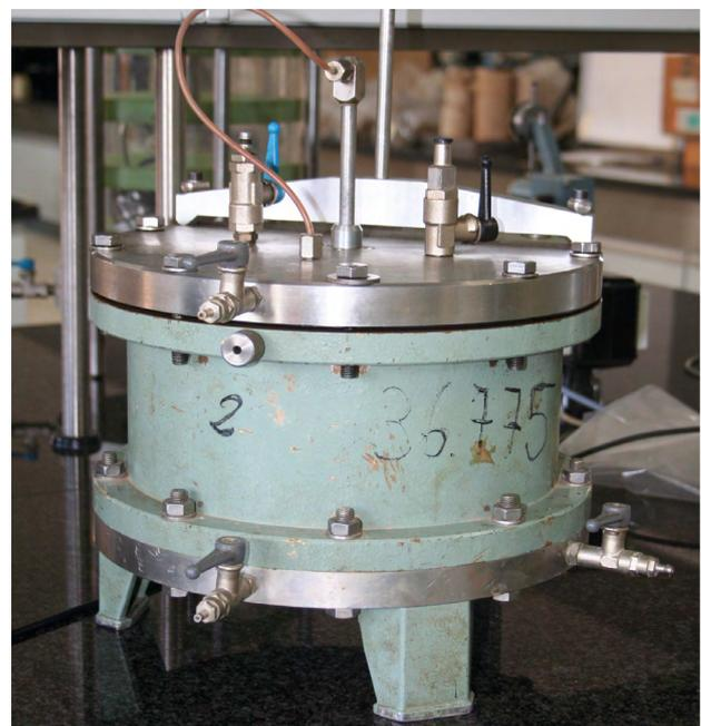
**Figura 1.** Célula Rowe empleada en los ensayos.
