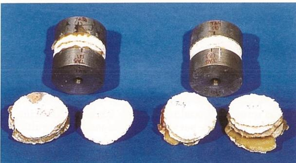
FOTOGRAFÍA 10. Detalle de probetas talladas y pegadas para ensayo.
