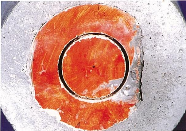
FOTOGRAFÍA 8. Detalle de la entalla en testigo.
