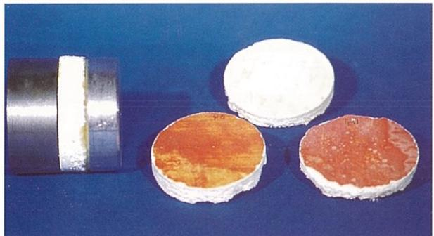
FOTOGRAFÍA 11. Preparación de probetas.
