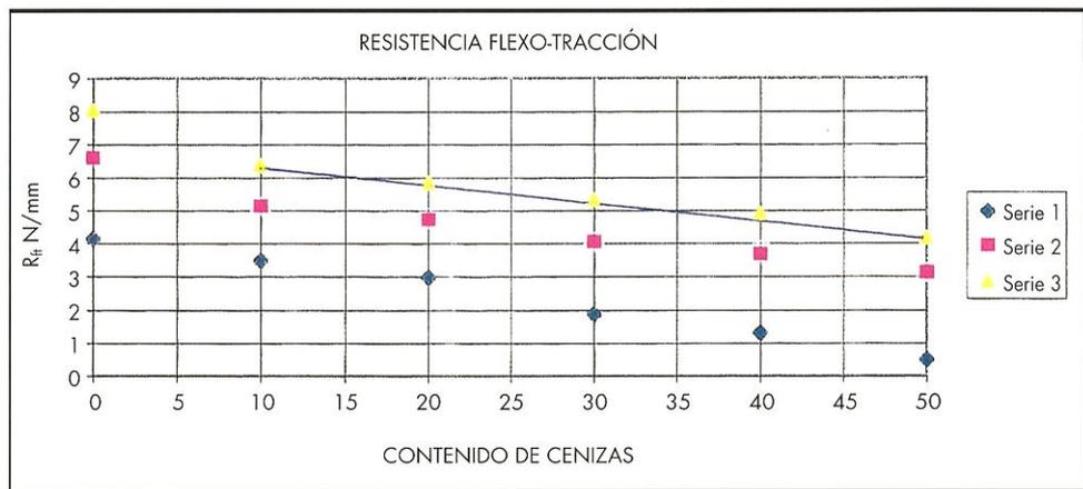
FIGURA 5. Variación de la resistencia a flexo-tracción con el contenido de cenizas.
