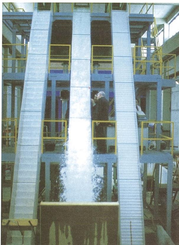
FOTO 3. Modelo de más de 7 m de altura para el estudio de rápidas escalonadas.
