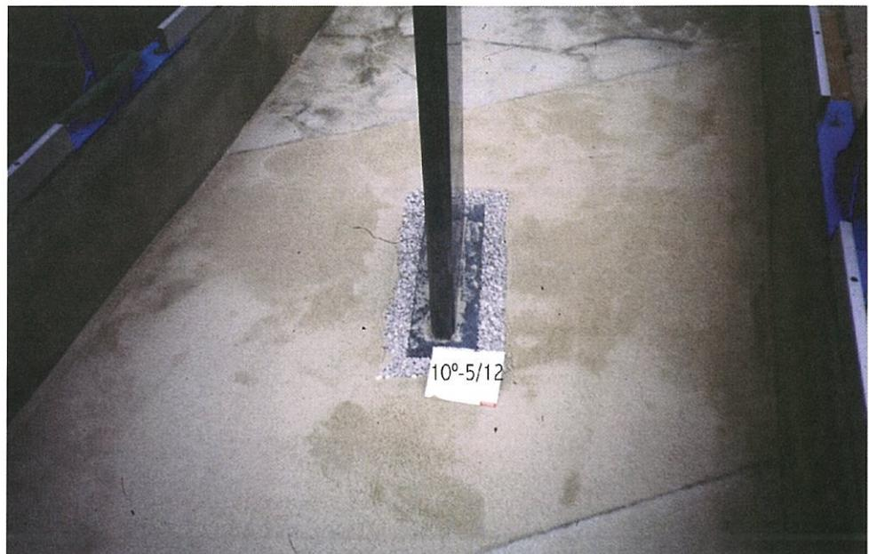
FIGURA 5. Foto de la escollera 5/12 preparada en el ensayo de 10 grados (zapata en superficie).
