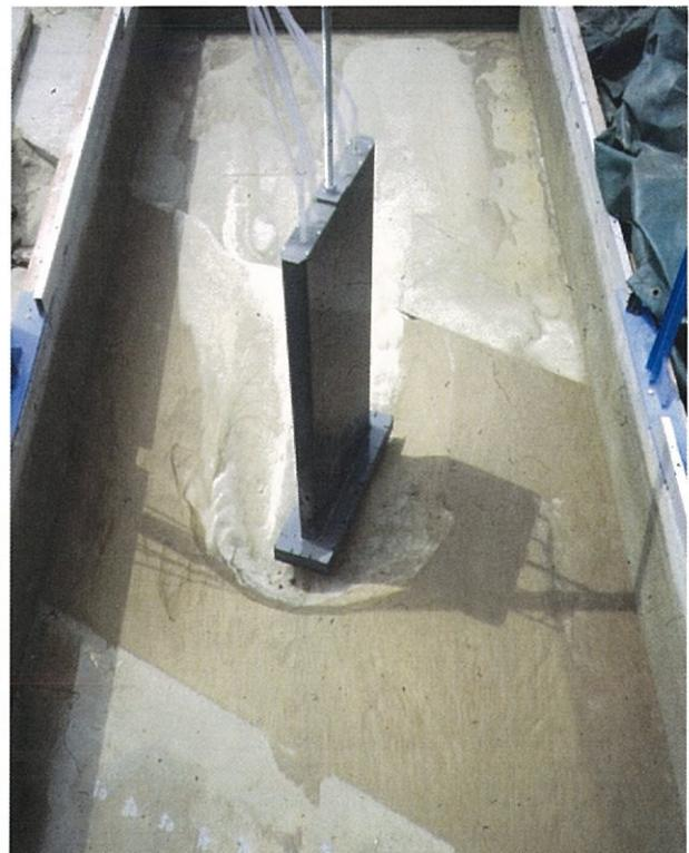
FIGURA 3. Foto del canal de ensayos (vista en dirección aguas abajo), pila sin protección.
