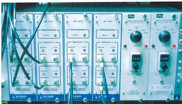
FIGURA 4. Electrónica asociada al detector de centelleo sólido de ZnS(Ag).
