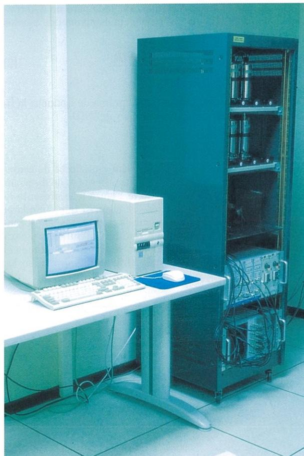
FIGURA 5. Vista completa del sistema detector de centelleo sólido de ZnS(Ag) de los laboratorios del CEDEX para la determinación del índice de actividad alfa total.
