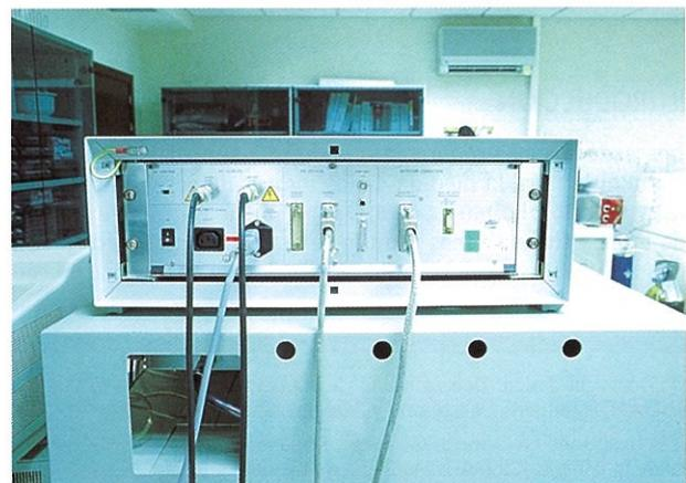
FIGURA 3. Sistema de adquisición de datos Data System LB 530PC.
