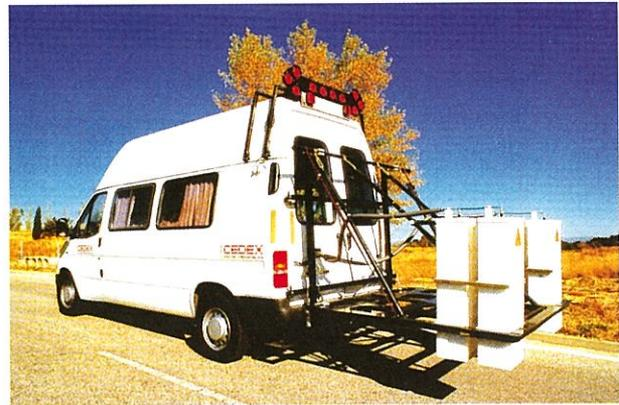
FIGURA 2. Equipo de georradar.
