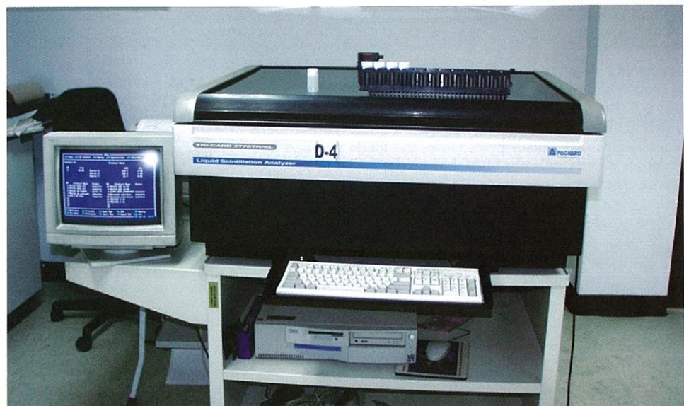
FIGURA 2. Espectrómetro de centelleo líquido Tri-Carb 2770TR/SL diseñado para la medida de niveles muy bajos de radiactividad.
