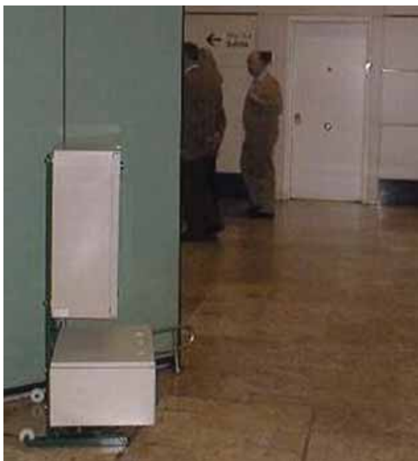
FIGURA 5. Equipo fijo de pedestal FHT-1372 de Thermo Eberline instalado en la salida de la aduana de pasajeros del aeropuerto internacional de Barajas.
