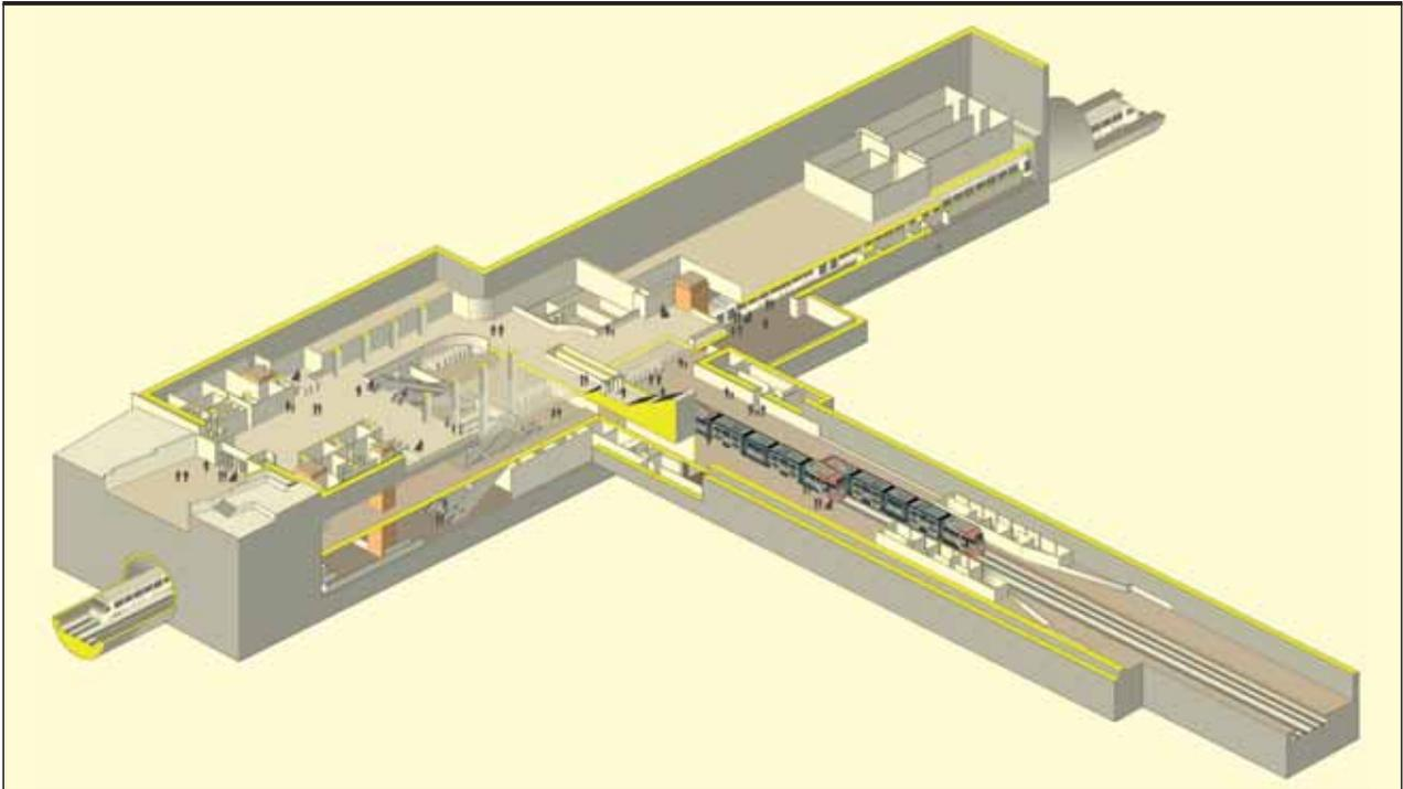
FIGURA 24. Axonométrica del Intercambiador de Colonia Jardín.
