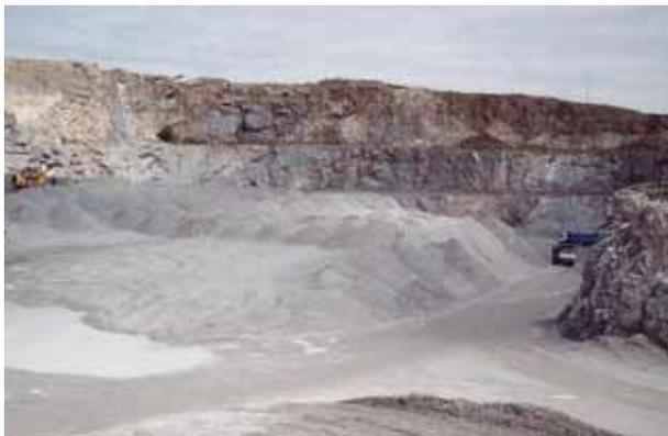
**FIGURA 17.** Acopio en una cantera de materiales excavados en un túnel, para su posterior venta. Segovia.
