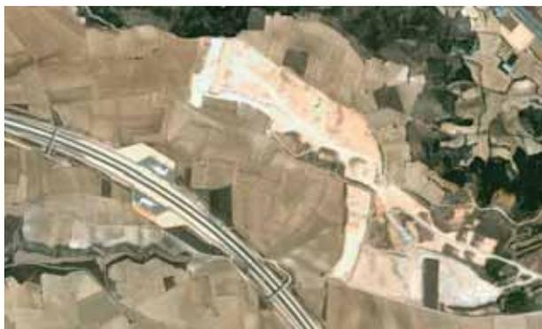
FIGURA 3. Préstamos junto a las obras abaratan el coste de obtención de materiales, hacen menos rentable la estabilización y desincentivan la optimización de balances.
