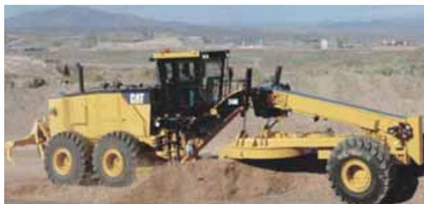
FIGURA 2. Motoniveladora Caterpillar, de 533 caballos, 62.456 kg de peso y 16 m de longitud (Fotografía: Caterpillar).
