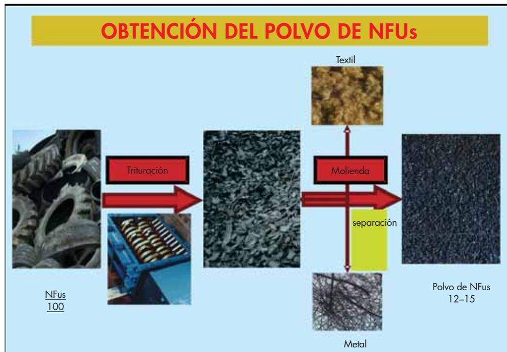
FIGURA 1. Esquema de la obtención del polvo de caucho.
