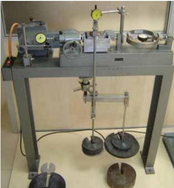
FIGURA 9. Equipo de corte directo empleado en los ensayos de rozamiento, perteneciente a la UPM.
