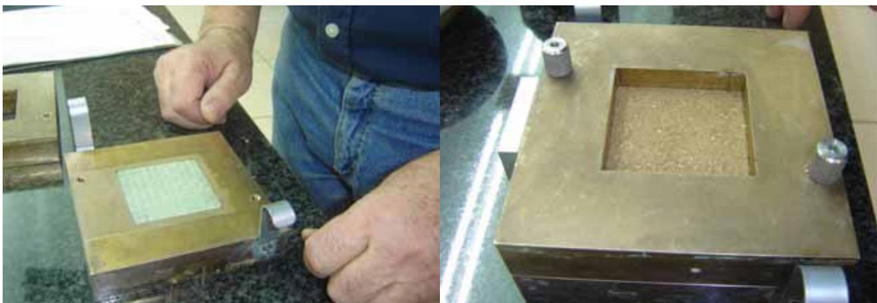
FIGURA 8. Colocación placa en material compuesto y preparación muestra para ensayos de rozamiento en equipo de corte directo.
