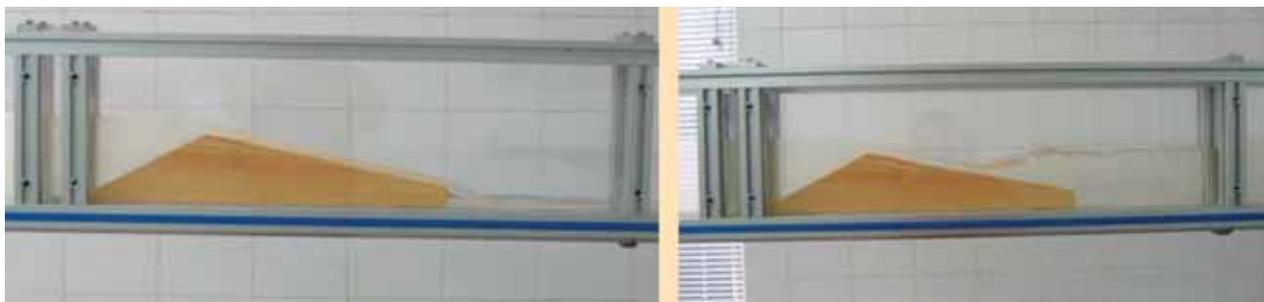
FIGURA 8. Izquierda: modelo reducido en el que se observa un salto en el truncado y el resalto tras el paramento de aguas abajo. Derecha: paramento con el truncado anegado y el cachón formado sobre éste (situación preferible para los peces).
