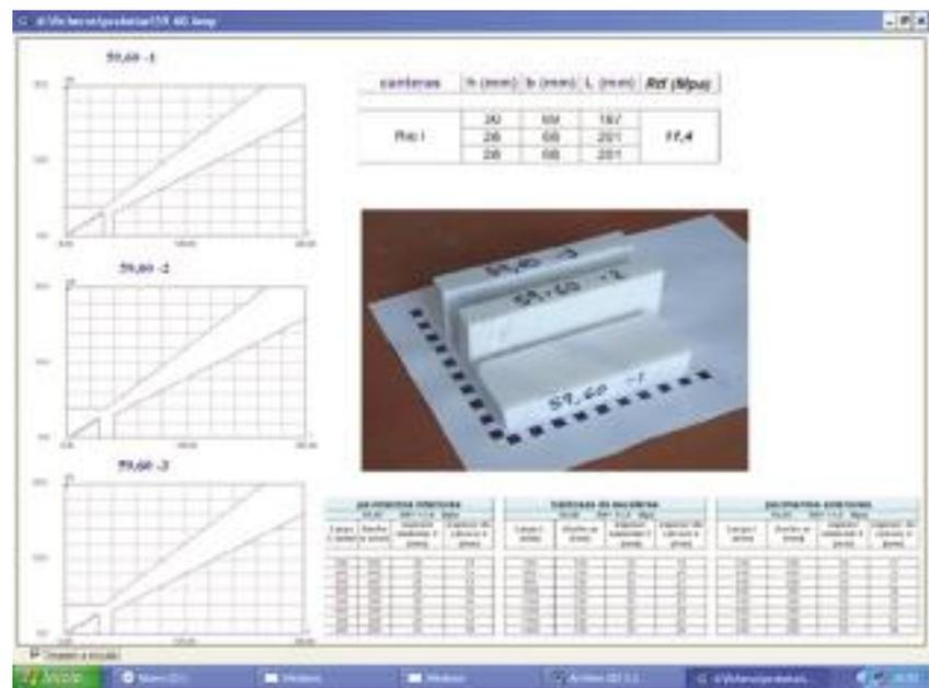
FIGURA 6. Resistencia a flexión y dimensionado de pavimentos de mármol blanco de Macael (muestras 59 y 60).
