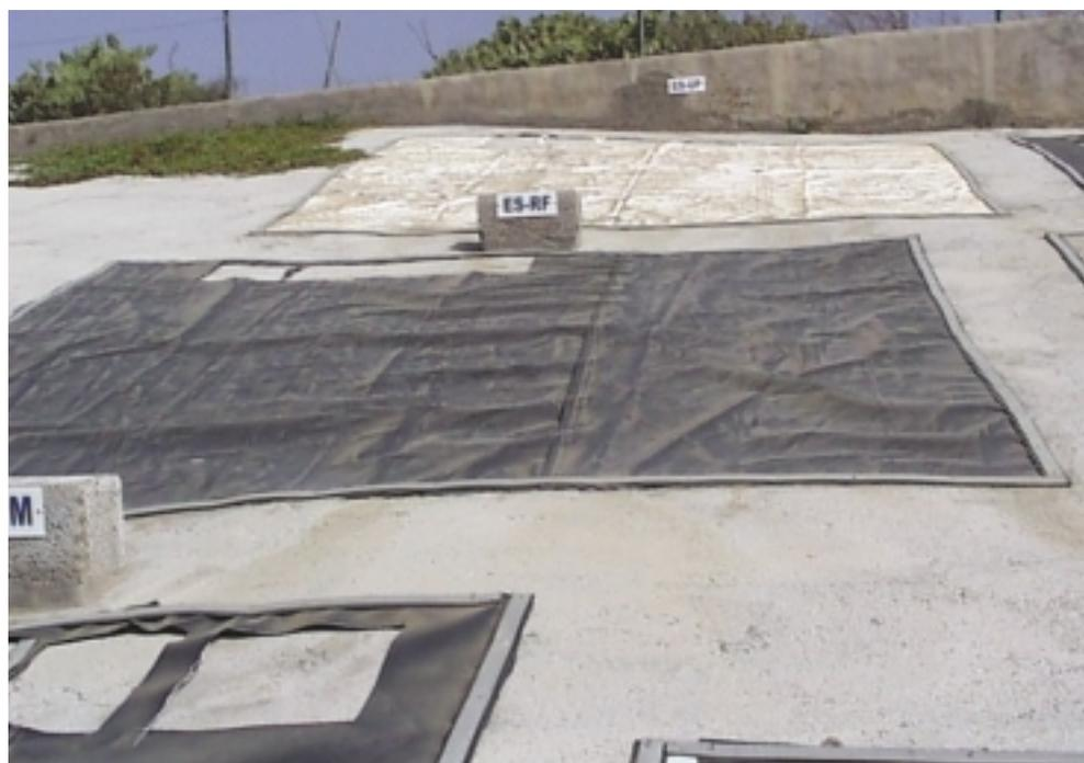
**FIGURA 2.** Geomembrana de poliolefina elastomérica en el campo experimental de El Saltadero.
