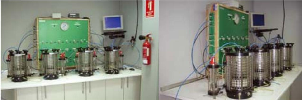
FIGURA 18. Equipo para la determinación de la permeabilidad.
