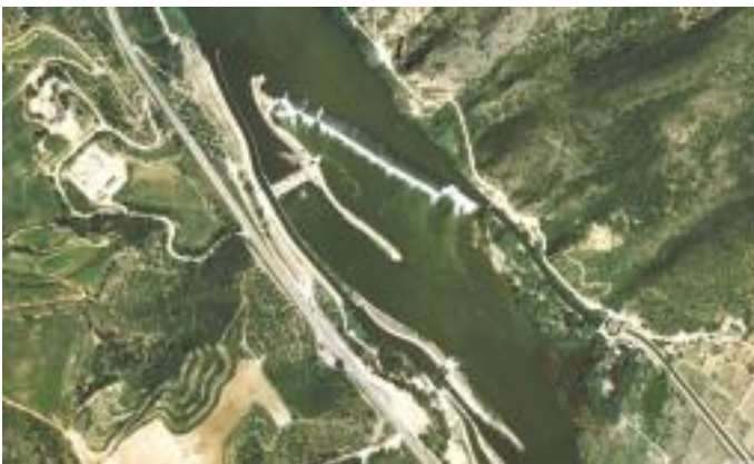
FIGURA 10. Azud de Xerta, en el río Ebro, de origen árabe. Se empleó para riego y molinero, y para favorecer la navegación. En la actualidad deriva agua para riego y aprovechamiento hidroeléctrico.
