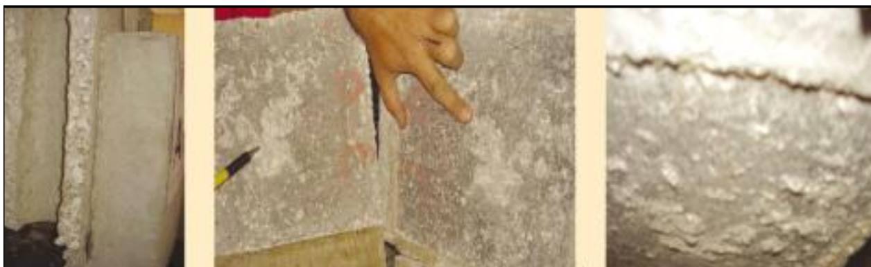
FIGURA 7. Vistas de superficies de fallo en la interfase.
