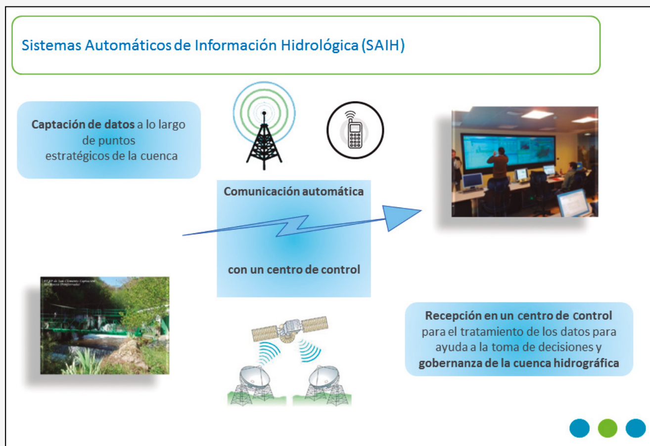
Figura 1. Esquema de un SAIH.
