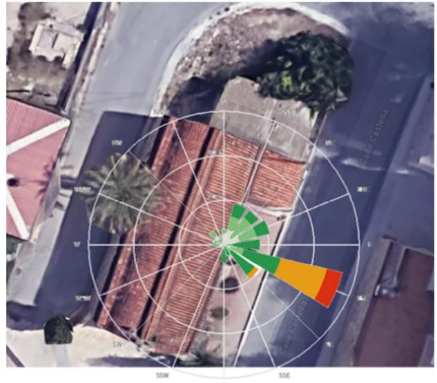
Figura 9. Actuación del viento en los 14 días anteriores al colapso.
