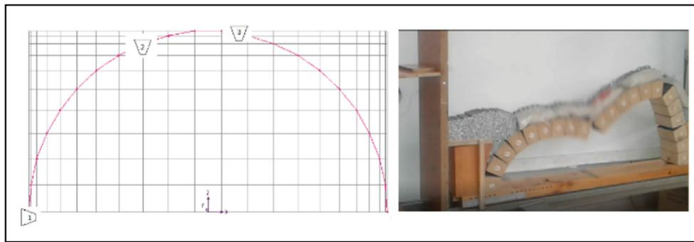
**Figura 20.** Modelización de los resultados frente a ensayo en modelo reducido.
