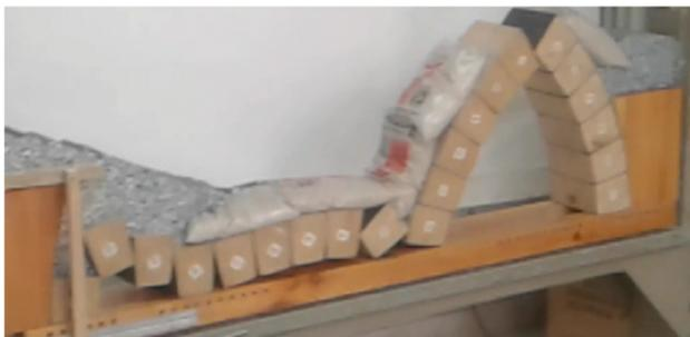
**Figura 21.** Situación de colapso del modelo reducido.
