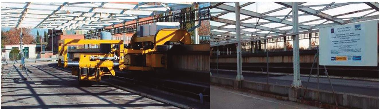
**Figura 3.** Tramos de prueba del proyecto LIFESURE en la pista de ensayo acelerado de firmes del CEDEX.
