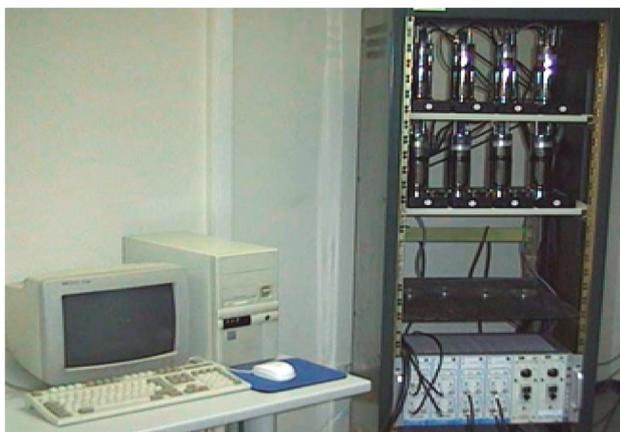
**Figura 13.** Detector de centelleo sólido de ZnS(Ag).
