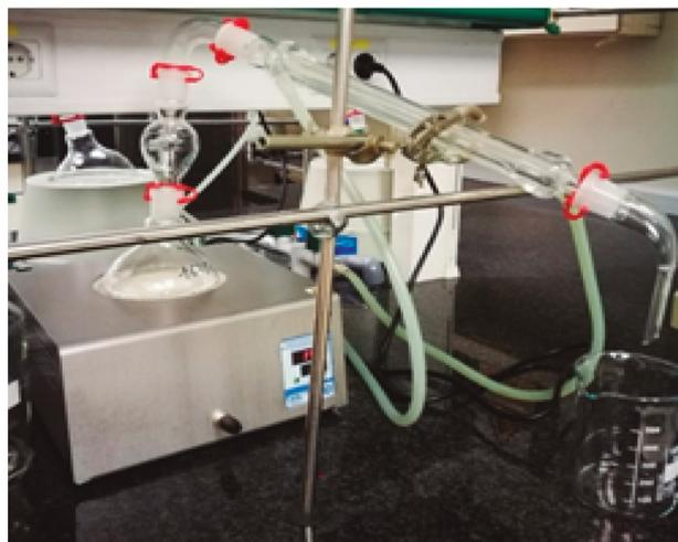
**Figura 10.** Primera destilación de la muestra para el análisis de tritio por concentración electrolítica.
