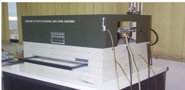
**Figura 15.** Contador proporcional de flujo continuo de gas Berthold 770-2.
