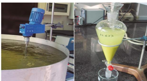
Figura 12. a) Depósito de agua para el análisis de cesio-137 y b) muestra en embudo de decantación.
