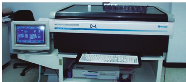
**Figura 17.** Detector de centelleo líquido.
