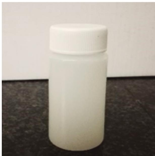
**Figura 9.** Vial de 20 ml para el análisis tritio en un equipo de centelleo líquido.
