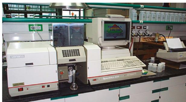
**Figura 16.** Equipo de Espectrofotometría de Absorción Atómica.
