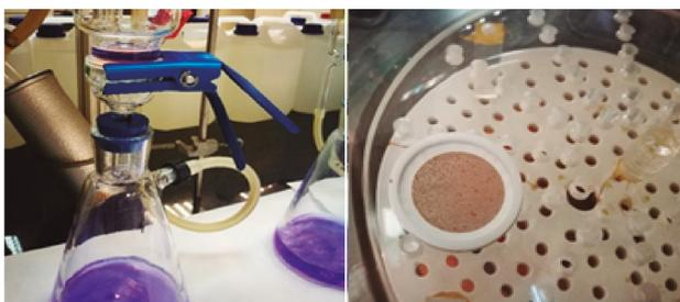
**Figura 6.** a) Filtración del precipitado final y b) plancheta con la muestra filtrada dentro de un desecador.
