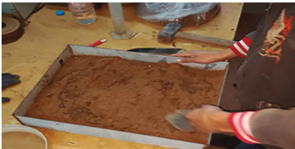
**Figura 3.** Preparación en laboratorio de Suelo-Arena-Emulsión.
