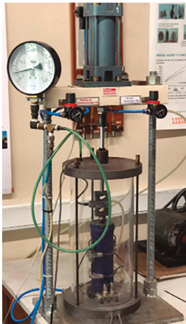
**Figura 6.** Ensayo triaxial dinámico para medida del módulo resiliente en suelos y materiales granulares.
