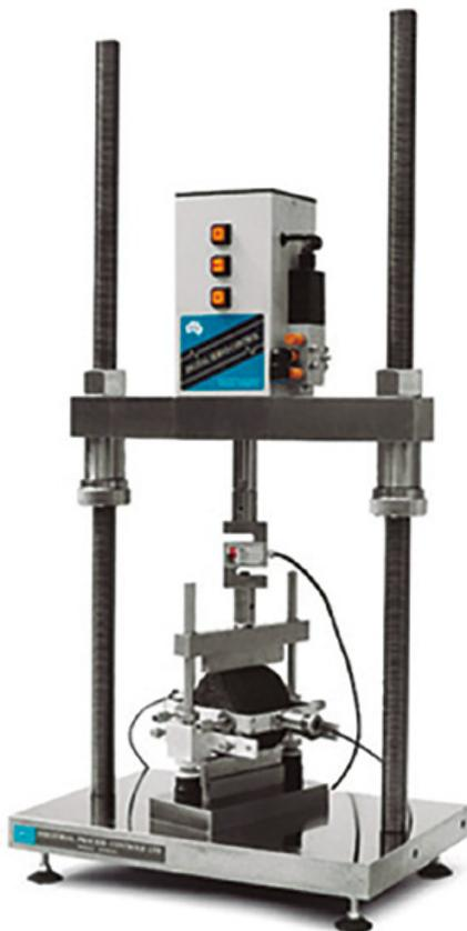
**Figura 7.** Equipo para medida del módulo dinámico a compresión diametral de materiales asfálticos.
