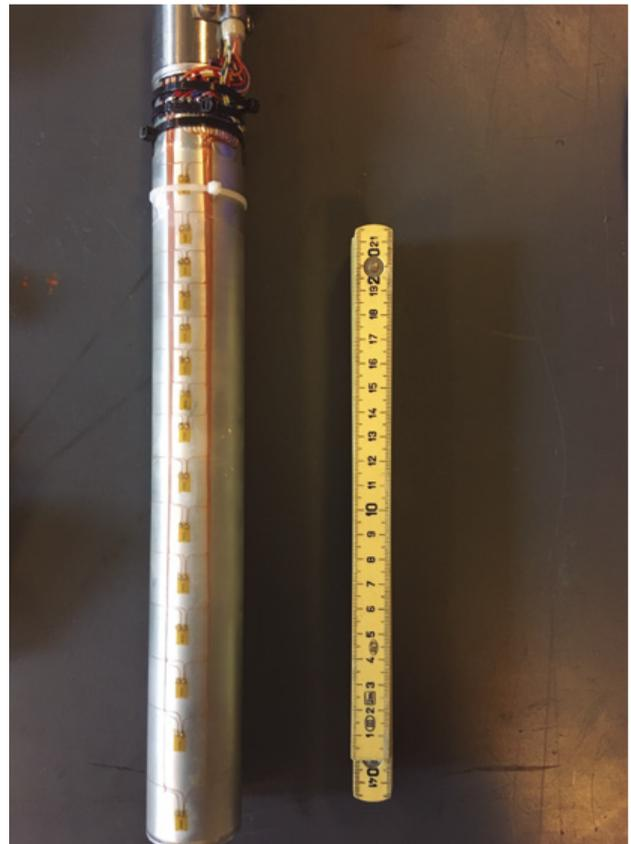
**Figura 14.** Pilote prototipo con medidores de la deformación empleado en los ensayos. (Foto tomada por Gema Urraca en DTU).
