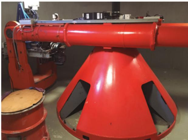
**Figura 13.** Centrífuga geotécnica de la DTU. (Foto tomada por Gema Urraca en DTU).
