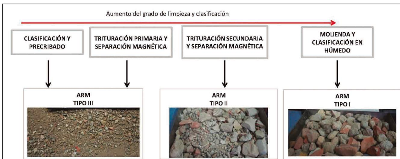
**Figura 13.** Tipos de áridos reciclados mixtos (ARM) considerados en el estudio del CEDEX en función del grado de tratamiento/limpieza al que son sometidos en las plantas.
