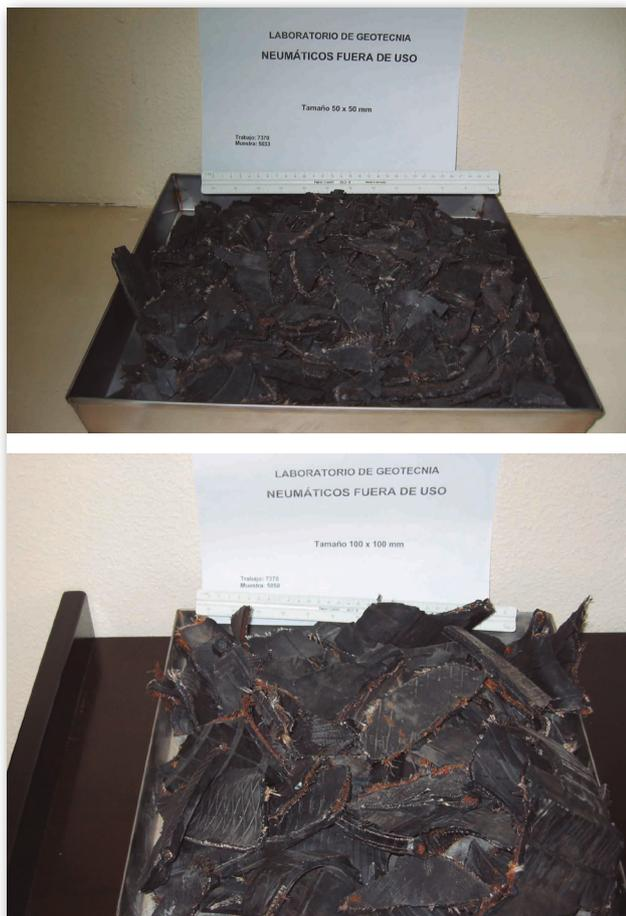
**Figura 5.** Vista de las muestras de tamaño nominal de 50 mm, y de 100 mm.
