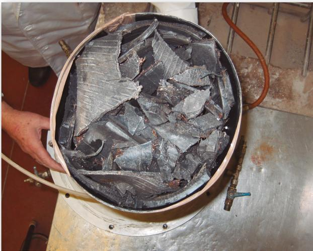
**Figura 7.** Muestra de tamaño 100 mm compactada en el interior de la célula de permeabilidad.
