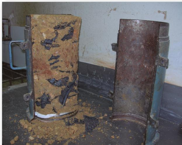
**Figura 6.** Desmontaje del molde de la probeta de compactación de mezcla de NFUt y suelo.
