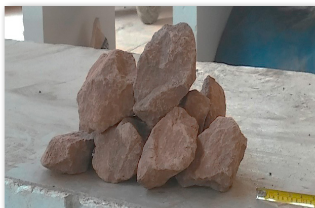
Figura 3. Arenisca roja Chocco-Cuartachaca con contenido de humedad: 11.5%, Límite Líquido: 38.45%, Límite Plástico: 20.81%, Índice de Plasticidad: 17.64%, Granulometría: T.M. : 1", T.M.N.: 3/8".
