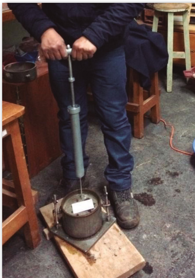
Figura 4. Prueba de fraguado en mortero de concreto con penetrómetro y aguja 1/40".
