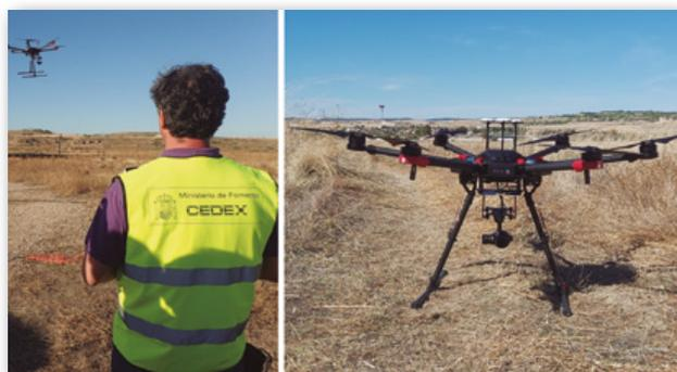
**Figura 8.** Dron propiedad del CEDEX preparado para realizar un vuelo fotogramétrico.
