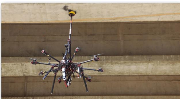
**Figura 7.** Dron DJI M600 con brazo telescópico y sensor de contacto de ultrasonidos (Fuente: CATEC).
