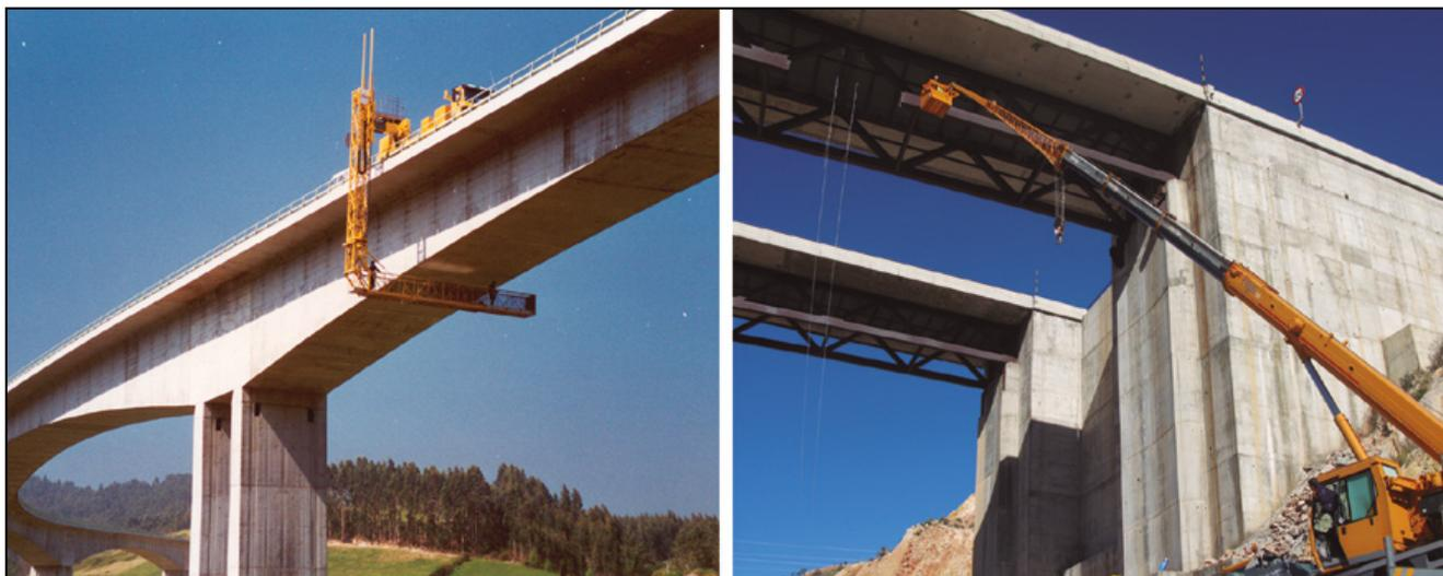
**Figura 4.** Medios de acceso tradicionales para inspección de puentes.
