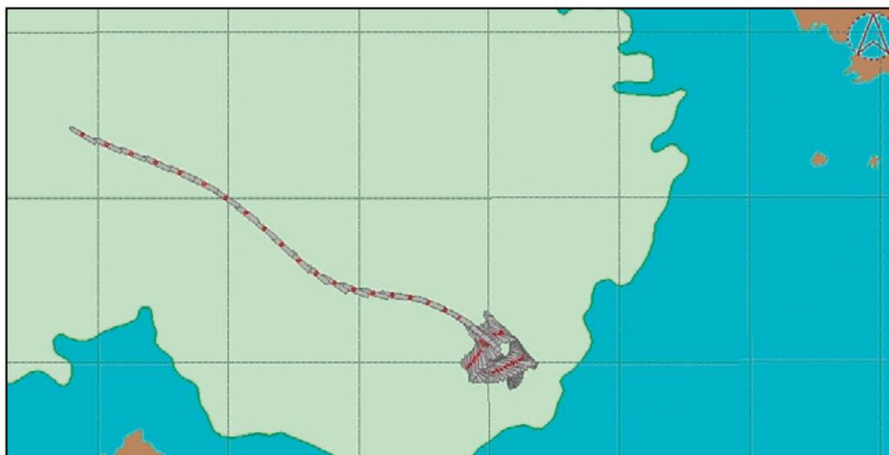
**Figura 3.1.5.** Trayectoria de la estancia del portacontenedores de 165 m de eslora y abandono del fondeadero con temporal de fuerza 8.
