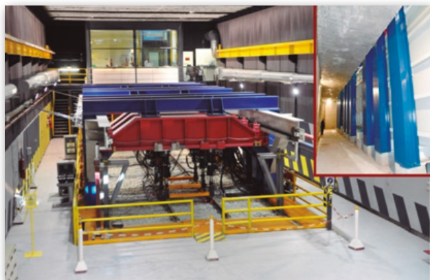
Figura 14. Vista general del Cajón Ferroviario del CEDEX.
