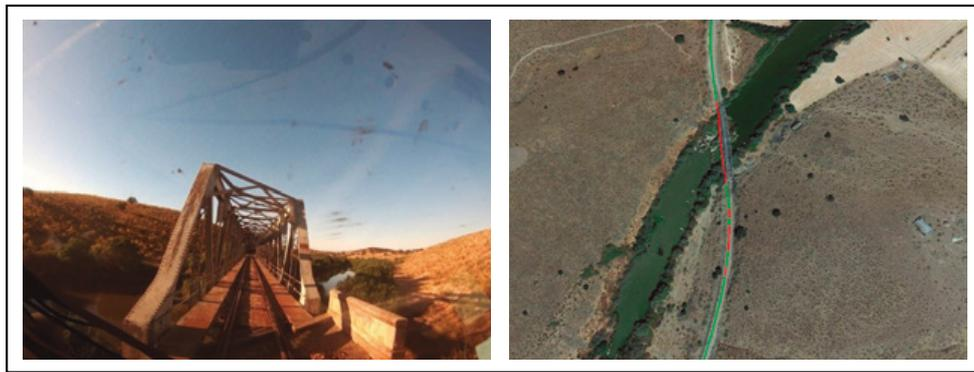
**Figura 19.** Ejemplo de detección de multipath en puente metálico sobre el río Zújar, seguido de una trinchera (Fuente: ERSAT-GGC y visualizado en Google Maps).
