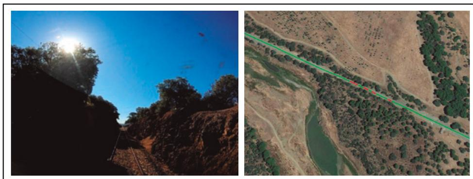
**Figura 21.** Ejemplo de detección de *multipath* zona de trinchera y árboles (Fuente: ERSAT-GGC y visualizado en Google Maps).
