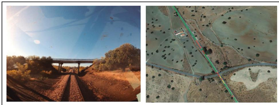
**Figura 20.** Ejemplo de detección de *multipath* paso elevado, con zona arbolada en el entorno (Fuente: ERSAT-GGC y visualizado en Google Maps).
