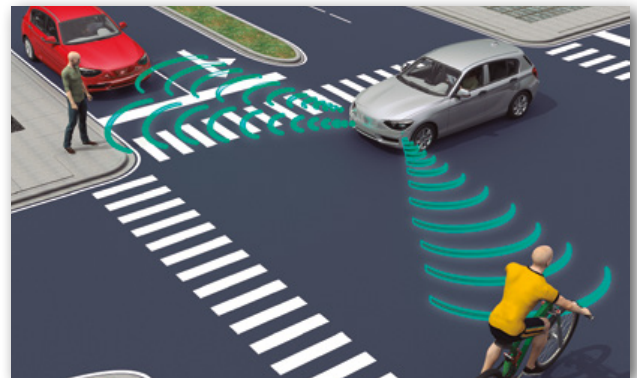
Figura 1. Detección de obstáculos mediante radar (Fuente: Shutterstock).
