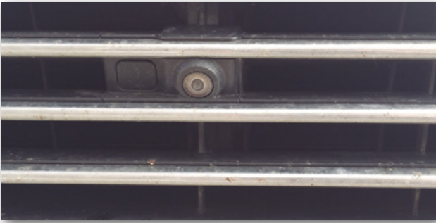
Foto 5. Vista de la cámara del sistema de visión artificial instalada en la parrilla delantera del vehículo.
