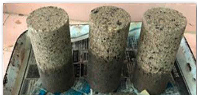
Figura 9. Ensayo de capilaridad para probetas de SAE.
