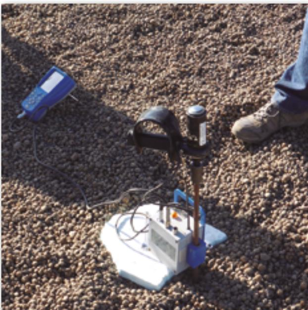
**Figura 18.** Penetrómetro Panda en un relleno de arcilla expandida realizado por Uriel & Asociados en una obra en Madrid.
