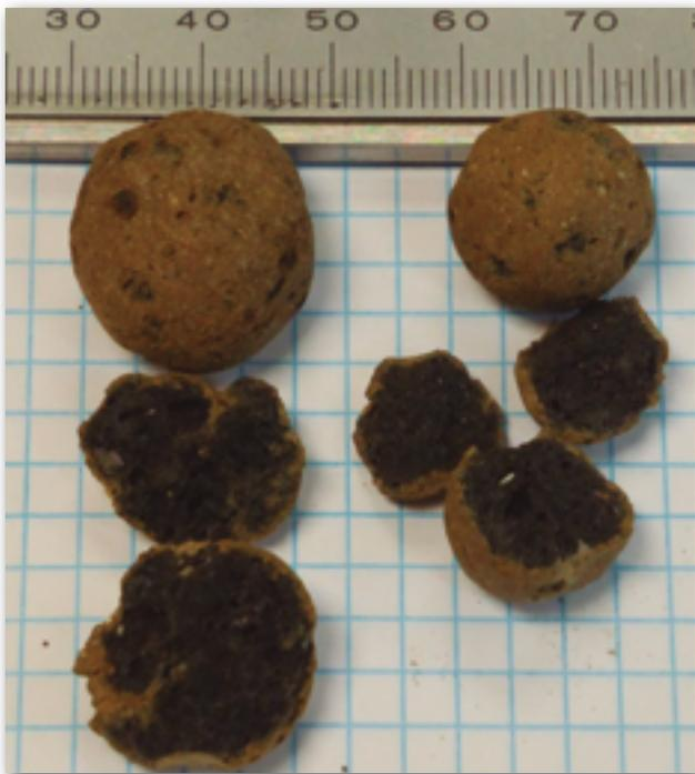
**Figura 2.** Granos de arcilla expandida enteros y fracturados. En los granos fracturados se observa claramente la frontera entre núcleo y cáscara.
