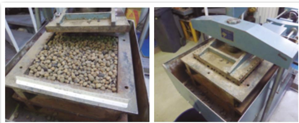
**Figura 10.** Equipo de corte directo de 30 x 30 cm con el que hicieron los ensayos con Arlita 10/20 en el LG-CEDEX.
