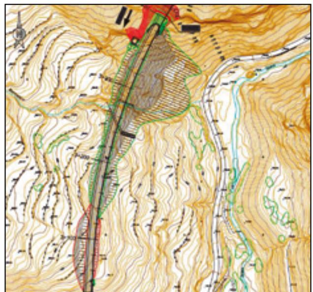
Figura 3. Pedraplén de acceso a la boca sur del túnel de Nueno. Definición en planta. D.O. 3+220 a 3+380 calzada Jaca-Huesca. Extraído de Cipsa Consulpal (2005).
