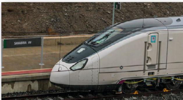
**Figura 4.** Morro, techo y laterales de cabina del Talgo AVRIL-S106 realizados en CFRP.
