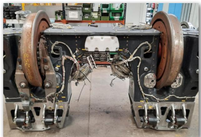
Figura 13. Prototipo 1 del rodal ligero (posición invertida para montaje). Incluye toda la instrumentación de galgas extensométricas para ensayo estático.
