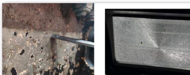
**Figura 10.** Daños por abrasión e impacto en un rodal en servicio y en una ventana.
