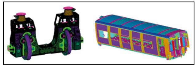
**Figura 8.** Modelo de elementos finitos (FEM) del rodal y de la caja.
