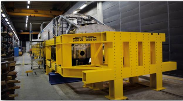
**Figura 16.** Banco de ensayo de cajas.
