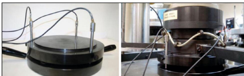
**Figura 40.** Ensayo para caracterizar los materiales elástoméricos. Detalle de los LVDTs (izda) y equipo durante el ensayo (dcha).
