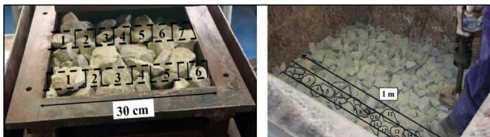
**Figura 39.** Balasto andesítico colocado en la caja de corte de 30 x 30 cm (izda) y en la caja de corte de grandes dimensiones (dcha).
