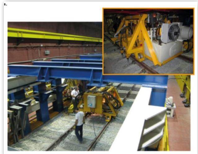
Figura 7. Máquina de bateo adaptada para su uso en el CFC.
