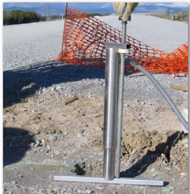
Figura 32. Sensor LVDT utilizado en la capa de balasto.
