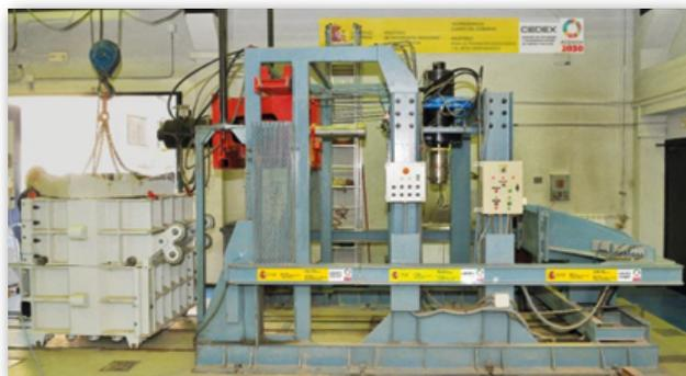
**Figura 36.** Caja de corte de grandes dimensiones del CEDEX usada para la caracterización del balasto.
