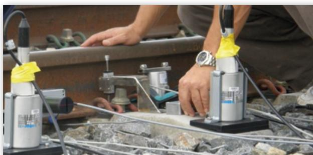
**Figura 29.** Potenciómetro y geófonos.
