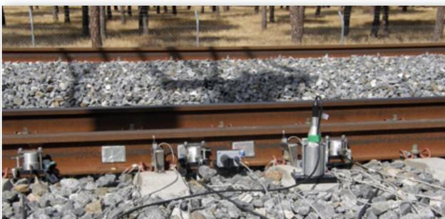
**Figura 18.** Instrumentación externa en sección ferroviaria.
