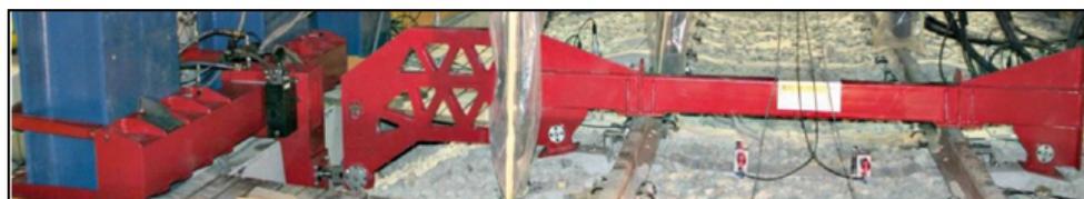
**Figura 10.** Fotografía del equipo para la realización de los ensayos de resistencia lateral de vía.
