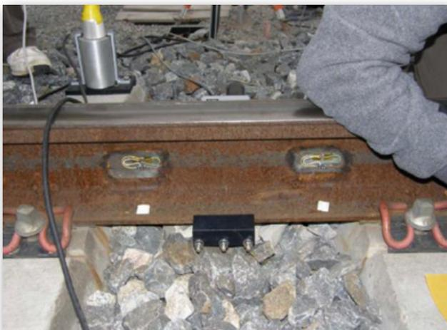
Figura 20. Colocación de bandas extensométricas en el carril.
