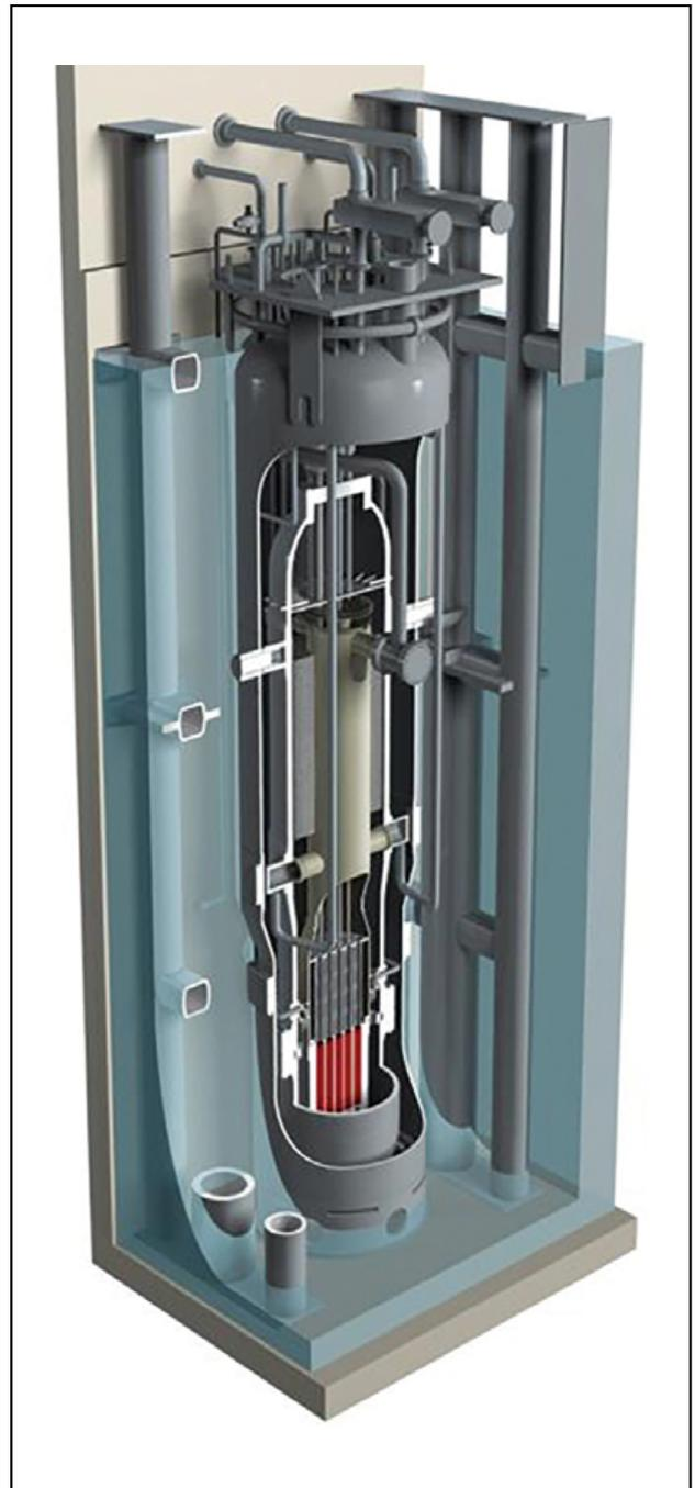
**Figura 7.** Perspectiva de corte del reactor *SMR* de NuScale (Fuente: NuScale Power LLC).
