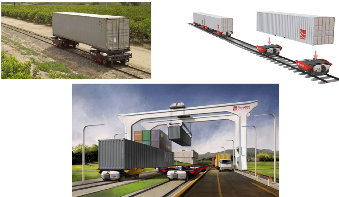
Figura 6. Sistema autónomo de transporte por ferrocarril de Parallel Systems.
