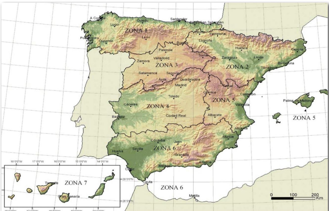
**Figura 2.** Zonas de clima invernal en España (Figura E.2 del DB SE-AE).
