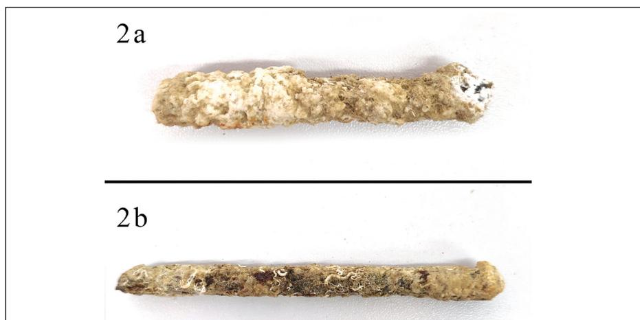
**Figura 2.** Detalle de la película de carbonato depositada sobre las estructuras de malla (cátodos). La figura A corresponde a una intensidad de 0,8 A y 60 días de paso de corriente. La figura B corresponde a 0,4 A y 100 días de paso de corriente (Imágenes: Carlos Antón).
