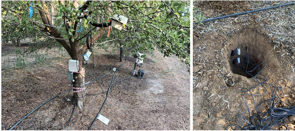
**Figura 1.** A la izquierda: sensores de planta instalados en una finca de almendro experimental en California, EE. UU. A la derecha: caudalímetro para el control de riego en una finca de pistachos en Córdoba, España.
