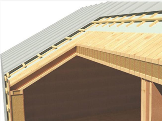
**Figura 6.** Eco Timber Cell (Fuente: TBetanzosHB).
