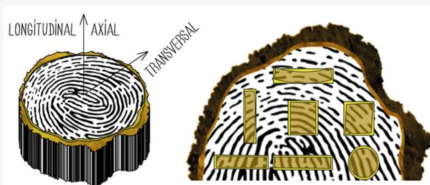
**Figura 1.** Anisotropía de la madera (Fuente: Toca Madera-Sounds Wood).
