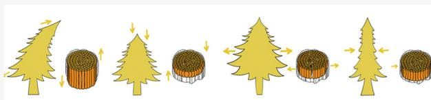
**Figura 2.** Tracción y compresión paralela y perpendicular a las fibras (Fuente: Toca Madera-Sounds Wood).
